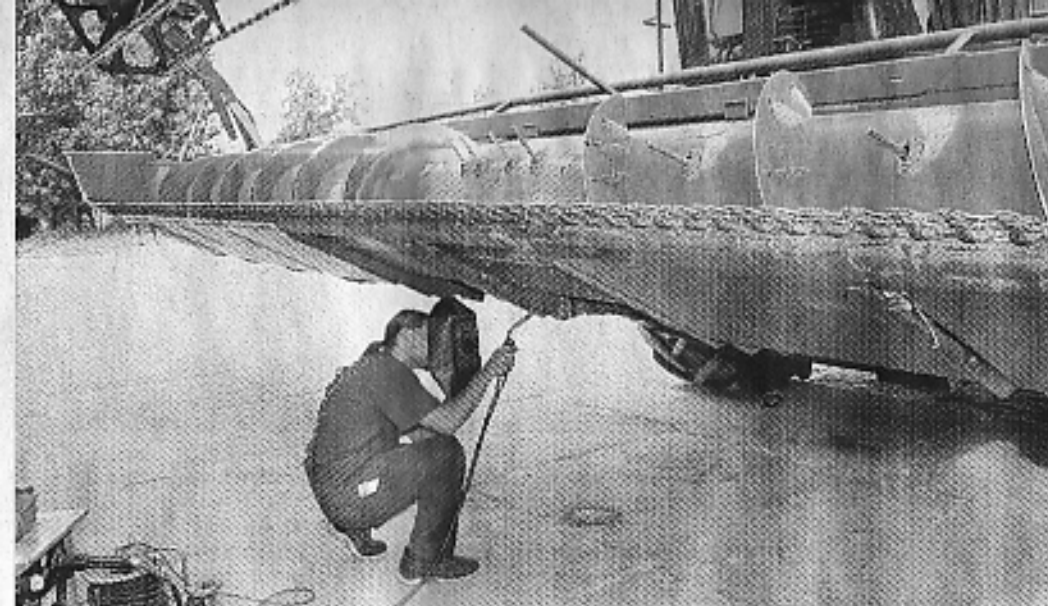
Ein großer Stein hat auf diesem Schneidwerk Schaden angerichtet. Christian Käding ersetzte die beschädigten Teile vor Ort in Altenweddingen.
